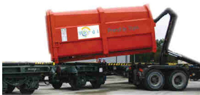
Le SMVO loue un parc de 50 wagons de type S83 multibercer à cadre pivotant à une filiale de la SNCF, la société Ermewa.
